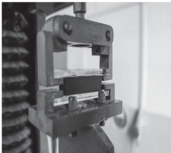
Fot. 57. Sposób umocowania próbki w maszynie wytrzymałościowej podczas badań adhezji [Archiwum Ł-ICiMB]
